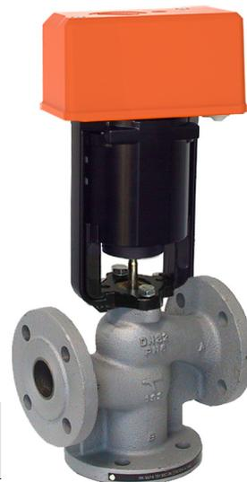
Grauguss-Durchgangsventil RF15..50/RF65K-BF für Stellantrieb MF100-SR-Z oder MF100-SR-Z-E, für Wasser bis 120 C, 16 bar
